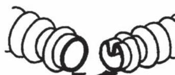
> Flexible pour aspiration des gaz d'échappement encliquetable par éléments / Hose for exhaust gas extraction by clipping different lengths
